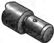
174-сүр. Конустук оюктун контуру толук көрсөтүлгөн кесилиштин мисалы
