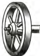
208-сүр. Арабанын дөңгөлөгү менен жан жыгачынын огуна эң жөнөкөй биригүүсү
