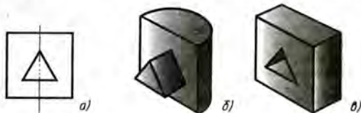
45-сүр. Сүрөттөлүштөрдөгү нерсенин формасынын аныксыздыгы
